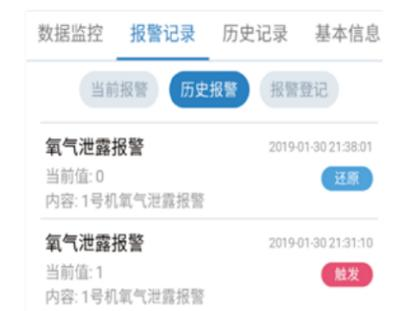
**分析：**正常情况下空气中氧气含量为 21%，所以氧气泄漏报警仪的上限报警值一般为 23%，下限值为 19%。在一般操作人员的理念中，氧气泄漏报警只会出现氧气泄漏情况，不会有氧气下限报警情况。这种情况下，可以打开设备间的通风，等数分钟后再进入设备间检查，如果还出现氧气泄漏下限报警，说明氧气泄漏报警仪故障。
